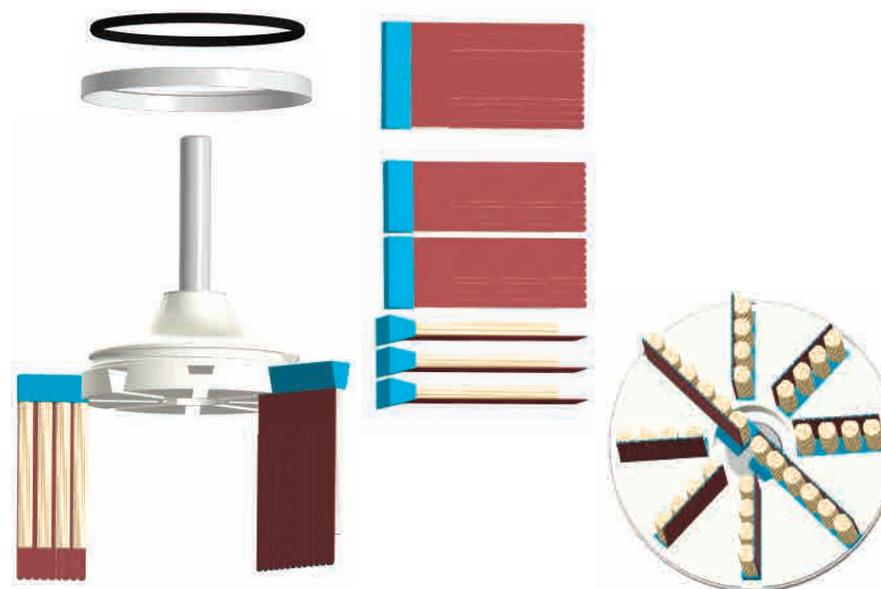
1. В пазы (II) поочередно вставьте 2 шлифовальных сегмента DE-TERO® Flex MB2 28 мм, а затем 6 шлифовальных сегментов DE-TERO® Flex MB2 18 мм.
